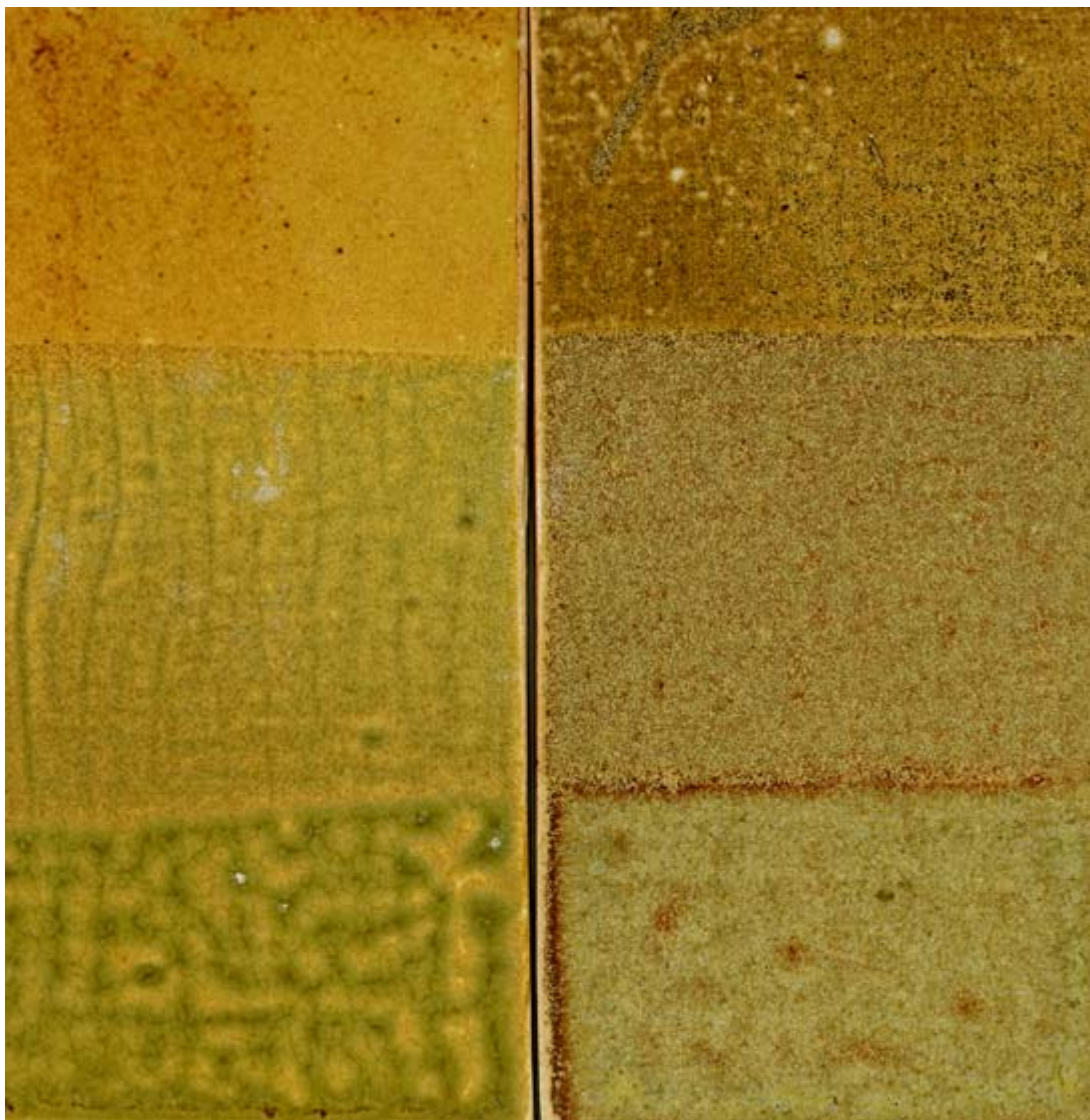
Kuva 18. Lasite LPD5 on poltettu puu-uunissa 1240°C ja 1260°C (oik.), pelkistävä poltto. Lasitteen vahvuus on ohut kerros ylin, keskellä kaksi kertaa ja alinna kolme kertaa. Lasitteen väri vaihtelee kerroksen paksuuden mukaan. Näyte on värikkäin keltaoranssi ja vihreä sävy.
