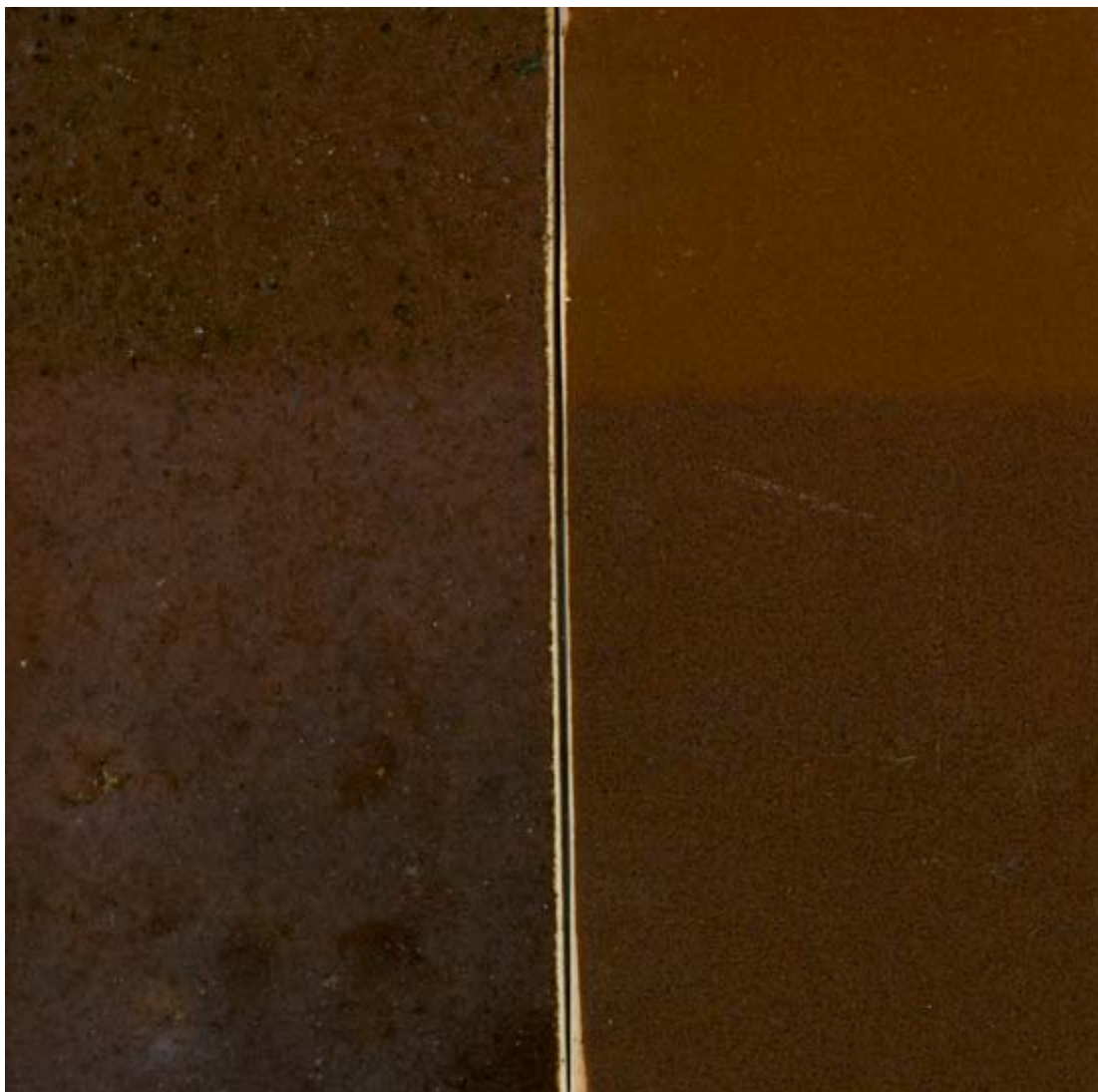
Kuva 2. Punasavinäyte LP1, Somero 1992 (vas.) on poltettu puu-uunissa pelkistävässä poltossa 1250^{\circ}\text{C} ja Albany slip savi vuodelta 1964 Amerikasta (oik.). Näyte on poltettu pelkistävässä atmosfäärissä kaasu-uunissa 1250^{\circ}\text{C} . Albany slip savi sulaa paremmin kuin Someron savi. Näytteissä on kolme eri kerrosta lasitetta. Ylinnä on yksi kerros keskellä kaksi kertaa ja alhaalla kolme, paksuin kerros.
