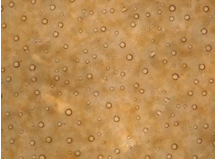
Kuva 26a. Lasite LPW5 mikroskooppikuvan suurennus 20. Hapettava poltto sähköuunissa 1250°C. Lasitteen vahvuus on kaksi kertaa.
