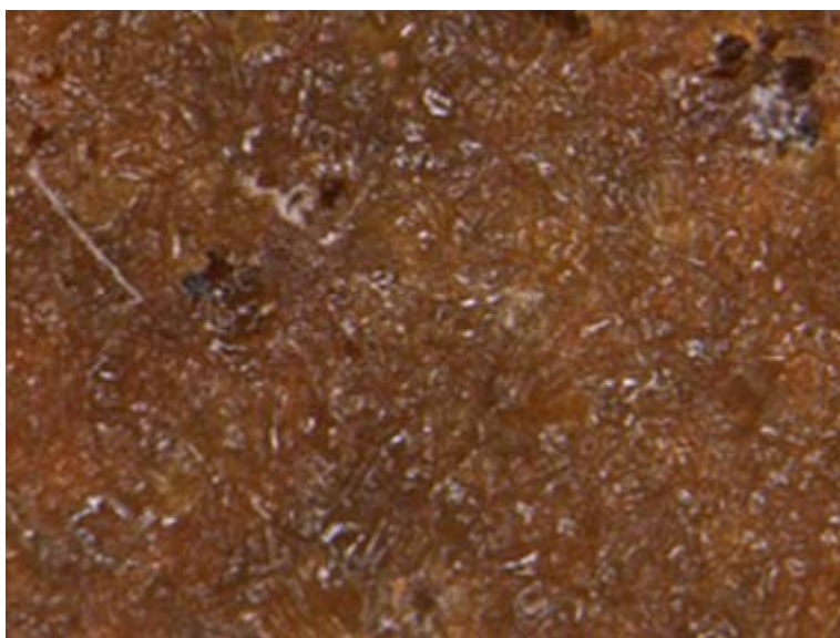
Kuva 5a. LPL3 mikroskooppikuvan suurennus 40. Pelkistävä poltto puu-uunissa 1250°C. Lasitteen vahvuus on kaksi kertaa.
