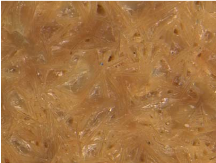
Kuva 15a. Lasite LPD4 mikroskooppikuvan suurennus 20. Näyte on poltettu sähköuunissa 1300°C. Lasitteen vahvuus on kaksi kertaa.
