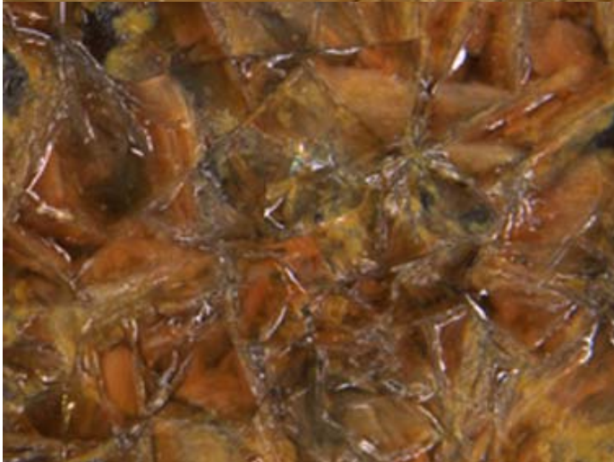
Kuva 26c. LPW5 mikroskooppikuvan suurennus 60. Rautaoksidin ja sekä kalsiumin ja magnesiumoksidin muodostama yhdistelmä, joka näkyy tummana pisteenä lasitteen pinnalla. Hapettava poltto sähköuunissa 1250°C. Lasitteen vahvuus on kolme kertaa.
