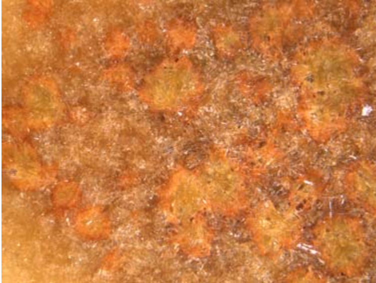
Kuva 8a. LPL5. mikroskooppikuvan suurennus 11.2. Sähköuuni poltto 1300°C. Lasitteen vahvuus on kaksi kertaa.
