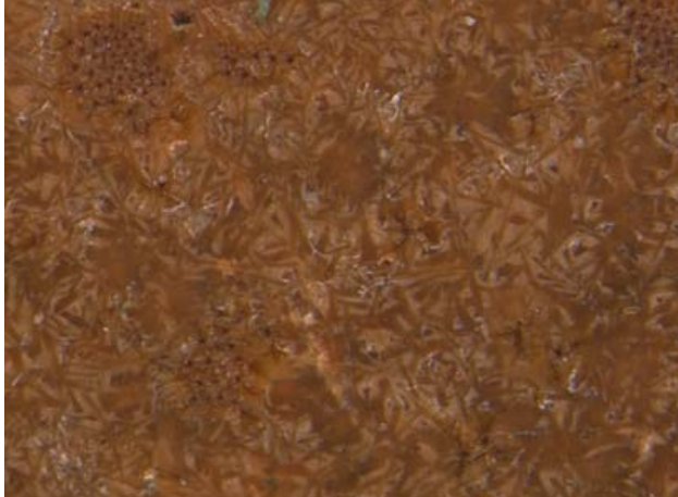
Kuva 11b. LPD2 mikroskooppikuvan suurennus 40. Sähköuuni poltto 1250°C 10 min haudutus. Lasitteen vahvuus on kolme kertaa.
