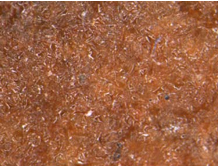
Kuva 7a. LPL4 mikroskooppikuvan suurennus 40. Pelkistävä poltto puu-uunissa 1250°C. Lasitteen vahvuus on yksi kerta.
