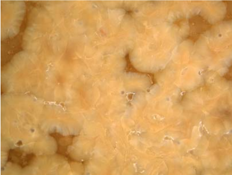
Kuva 17a. Lasite LPD5 mikroskooppikuvan suurennus 11.2. Sähköuuni poltto 1250°C 10 min haudutus. Lasitteen vahvuus on kaksi kertaa.
