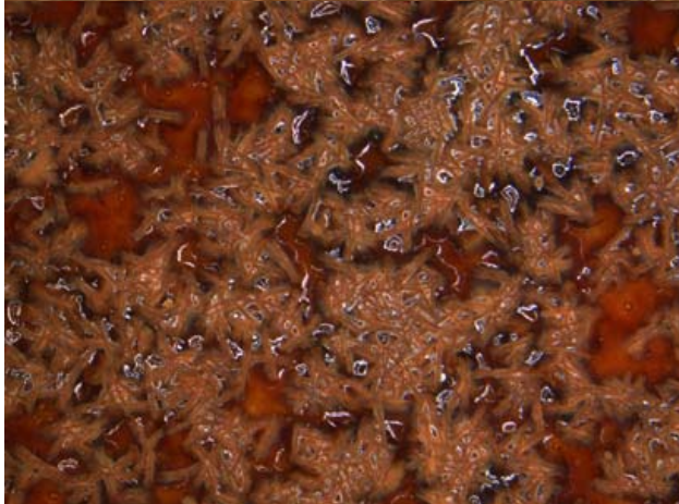
Kuva 11c. LPD2 mikroskooppikuvan suurennus 11.2. Sähköuuni poltto 1300°C. Lasitteen vahvuus on kaksi kertaa.
