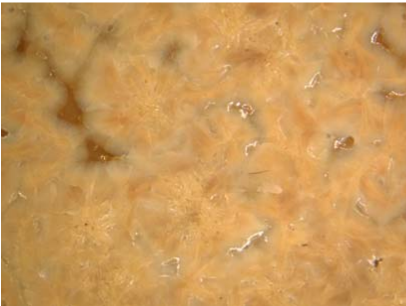
Kuva 17b. LPD5 mikroskooppikuvan suurennus 11.2. Sähköuuni poltto 1250°C 10 min haudutus. Lasitteen vahvuus on kolme kertaa.
