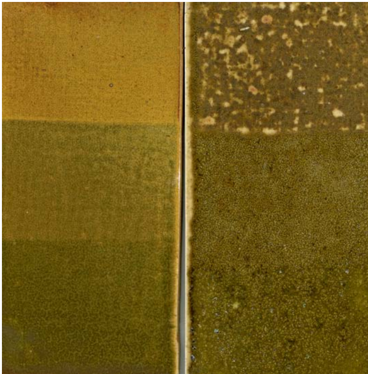
Kuva 16. LPD4 pelkistävä poltto puu-uunissa 1250°C ja 1260°C. Lasitteen vahvuus on ohut kerros ylin, keskellä kaksi kertaa ja alinna kolme kertaa, kuroutunut alue. Lasitteen väri vaihtelee kerroksen paksuuden mukaan.
