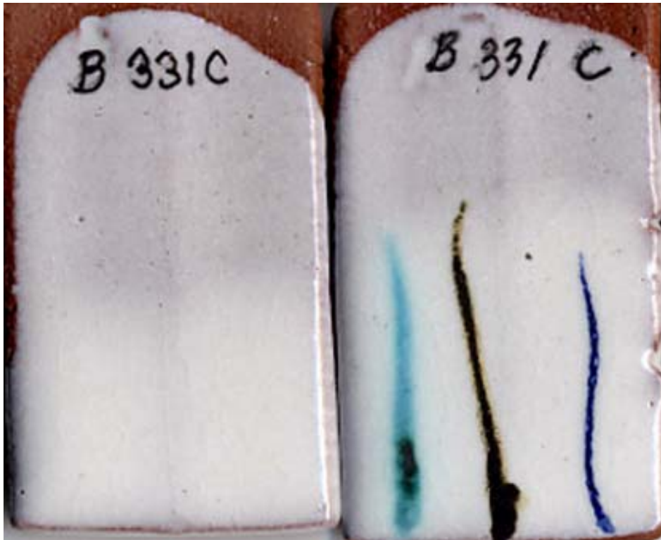
B331C, 1020°C ja 15 minuutin haudutus. Hyvä peittävä majolika- lasite.
