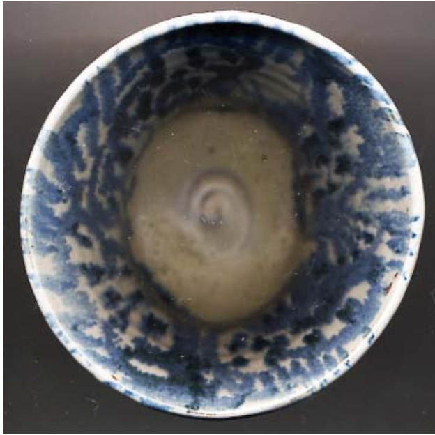
A351B lasite. Lyijysulatteella sulatetulla ja tina- ja titaanioksidilla kellertäväksi, peittäväksi lasitteeksi värjättyllä lasitteella on lasitettu punasavikulho. Lasitteen pinta on himmeä ja kellertävä.
