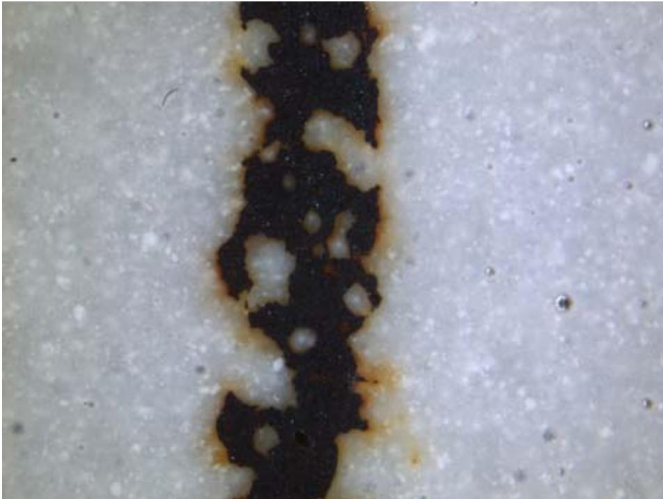
A34C suurennos 11.2. Yksityiskohta. Rautaoksidiviiru on maalattu lasitteen päälle. Peiteaineseos, tinaoksidi 5% ja-zirkoniumsiliikaatti 5%, näkyy valkoisina pilkkuina. Suuret kuplat lasitteessa osoittavat lasitteen hyvää sulamista.
