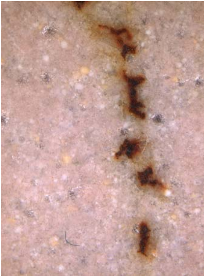
B332B, 11.2 suurennus. Rautaoksidiviiru on ruskeakeltainen. Peiteaineseos, tinaoksidi 5% ja titaanidioksidi 5% näkyy vaaleanpunaisina ja valkoisina pilkkuina. Poltto 1020°C, 15 minuutin haudutus
