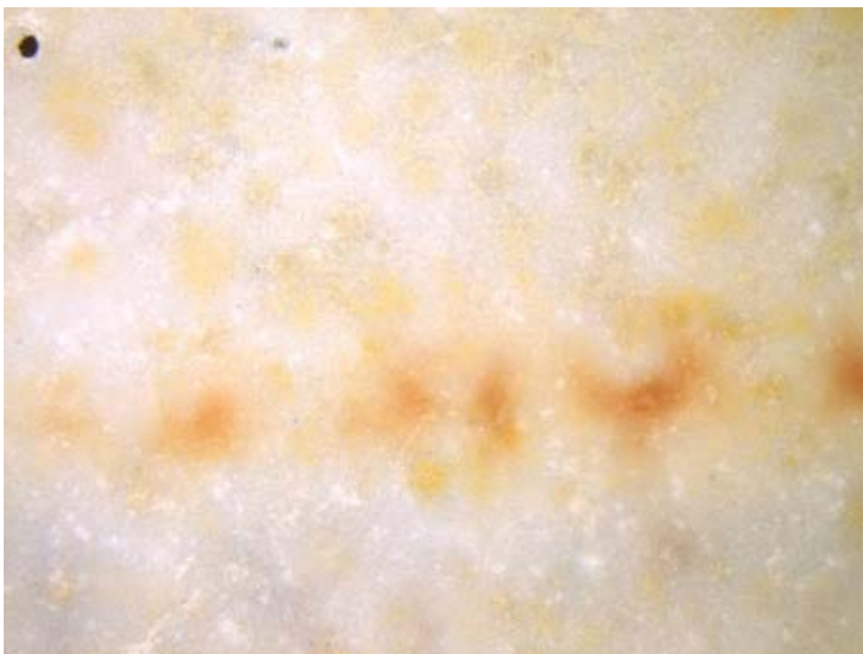
A351B rautaoksidi 11.2 suurennus. Rautaoksidiviiru on maalattu lasitteen päälle. Peiteaineseos, tinaoksidi 5% ja titaanidioksidi 5% näkyy vaaleankeltaisina ja valkoisina pilkkuina.
