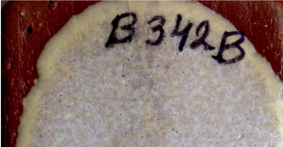
B342B, 1050°C ja 15 minuutin haudutus, yksityiskohta näytteen yläosasta. Lasitteen ja massan rajapintaan muodostuu kalsium- ja rautaoksidin reagoiessa keltainen reunus. Sulate höyrystyy ja sintraa massan pinnan.
