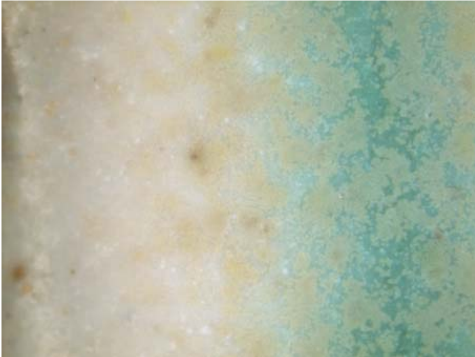
A351B kuparioksidi 11.2 suurennus. Kuparioksidiviiru on maalattu lasitteen päälle. Peiteaineseos, tinaoksidi 5% ja titaanidioksidi 5% näkyy vaaleankeltaisina ja valkoisina pilkkuina.
