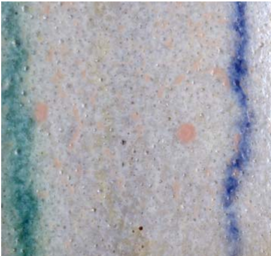
B342B, 1050°C ja 15 minuutin haudutus, yksityiskohta. Titaanioksidin vaikutus näkyy vaaleanpunaisina pilkkuina.
