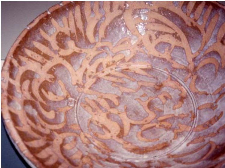
Kuva. Vuolukivimassasta dreijattu vati. Se on lasitettu flogopiittikiillettä sisältävällä lasitteella, joka on ohuena kiiltävä ja paksuna valkoinen opaali. Vahakoristelun alta paljastuu massan väri polttolämpötilalla 1100°C (Hortling 1997)
