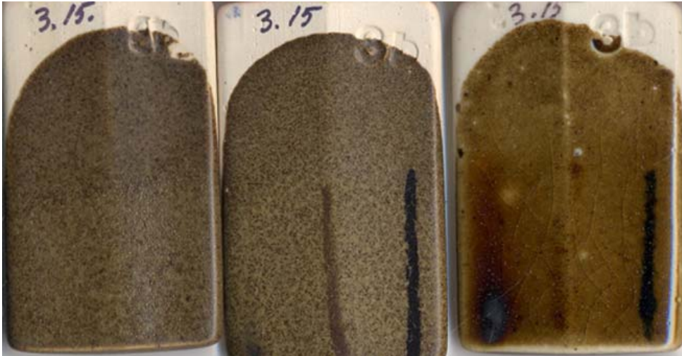
Näyte (3.15) sisältää punasavea, mistä tulee ruskea väri. Näyte sulaa 1250°C (2vas.), Näyte sulaa sintraantuvan massan päällä 1300°C (oik.).
