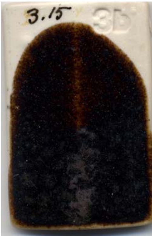
Näyte (3.15) sisältää punasavea ja vuolukivijauhetta, mistä tulee tumma ruskea väri. Paksun lasitekerroksen päälle syntyy tummia rautakiteitä, jotka näkyvät näytteen alaosassa keskellä. Näyte sulaa 1300°C.
