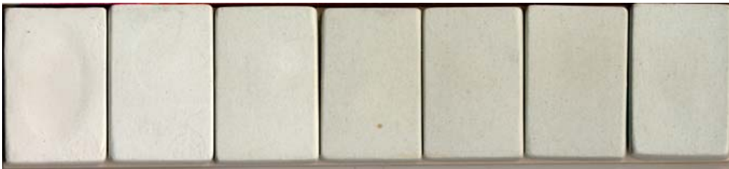
Kuva. Apatiittimassa säilyttää apatiitille luonteenomaisen vihertävän väri polttogradientissa jonka maksimi lämpötila (oikean puoleisin levynäyte) on 1300°C.
