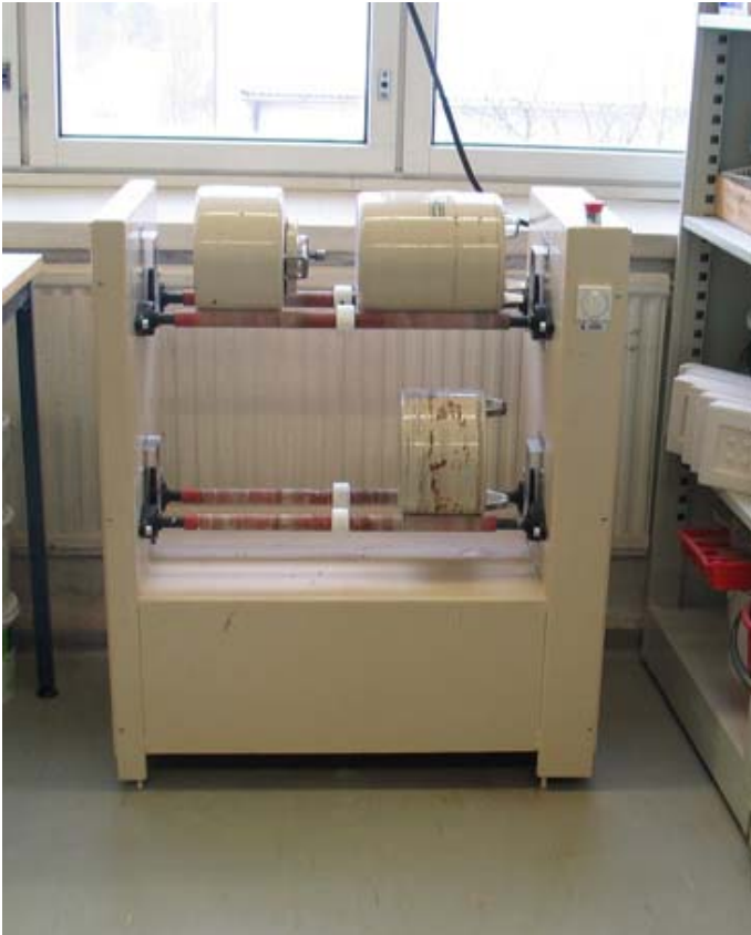
Kuva. Taideteollisen korkeakoulun laboratorioon on teetetty (Keracomp Oy, Porvoo) pieneen tilaan sopiva kaksikerroksinen kuulamyllyn pyöritysalusta, jolla voi pyörittää useita myllyjä samanaikaisesti.
