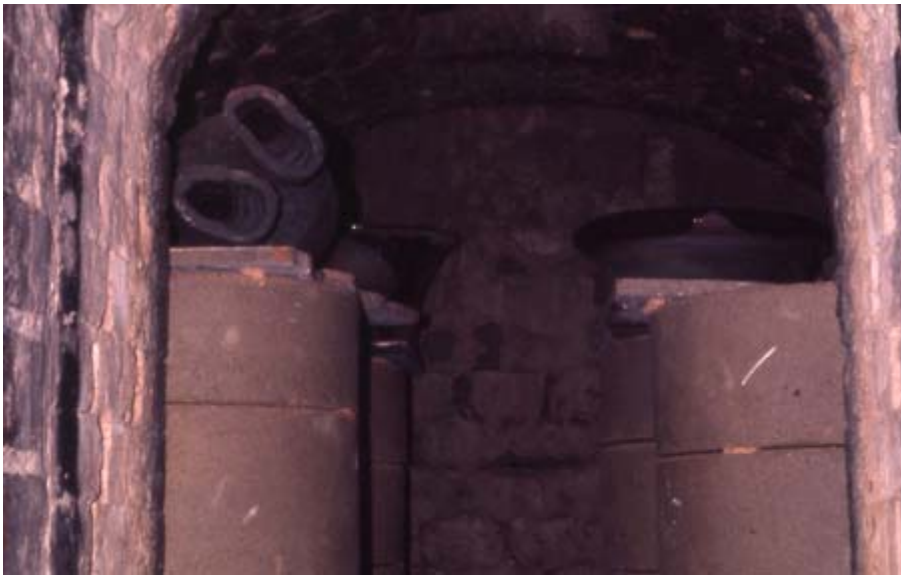
Kuva. Uunikasetit suojasivat lasitepintoja polton aikana tuhkalta. Uunin sisätilassa on kasetteihin ladottu poltettavat esineet vuonna 1971. Ateneumin taidemuseon sisäpihalla oli erillinen rakennus, jossa sijaitsi 1930 rakennettu puu-uuni, siinä poltettiin opiskelijoiden työt, jotka ladottiin kasetteihin. Kasetit oli valmistettu kapselimassasta Arabian tehtaalla.
