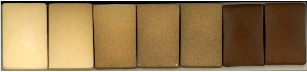
Kuva. Apatiittia ja flogopiittikiillettä on käytetty yhdessä raaka-aineena kivitavaramassassa, josta on poltettu gradientti maksimilämpötilaan 1225°C.
