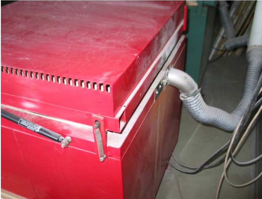
Kuva Vuolukivinäytteet on poltettu sähköuunissa, 110-litrainen malli, Kerako polttouuni, jonka maksimi polttolämpötila 1300°C. Uunissa on alipaineistettu polttokaasujen poisto.
