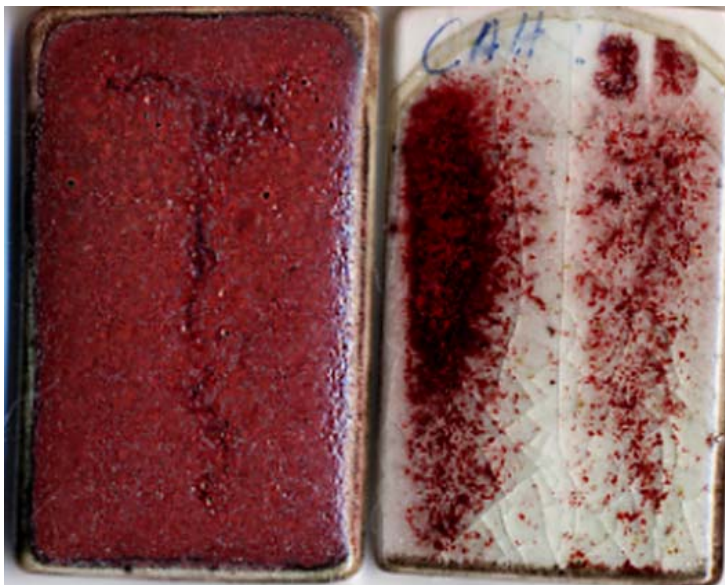
CAH23A ja alla CAH23B poltto kaasuuuni 1260°C. Kaksi lasitetta päällekkäin.
