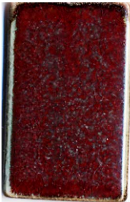
CAH22A ja alla CAH22B poltto kaasu-uuni 1260°C. Kaksi lasitetta päällekkäin.
