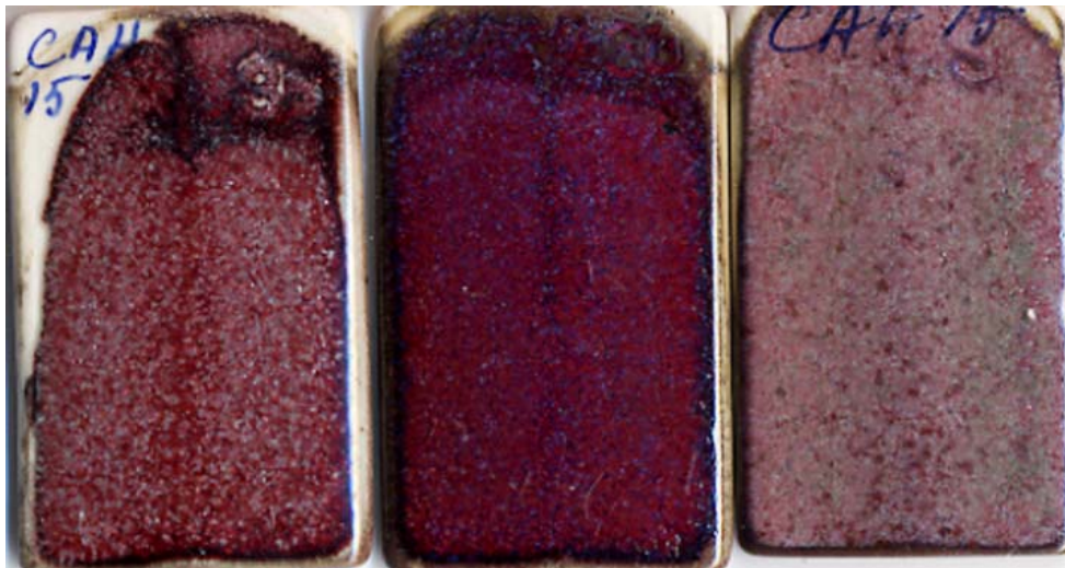
CAH15A ja B, kaasu-uuni 1240-1260°C. Oikeanpuoleinen on sulanut vähän.
