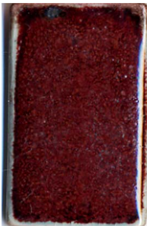
CAH21A ja alla CAH21B, poltto kaasuuuni 1260°C. Kaksi eri lasitetta päällekkäin
