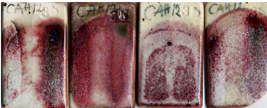
Lasite CAH12 1260-1280°C, kaasuuuni. Mikroskooppikuva kertoo värin kehittyvän lasisulassa pinnan alla.
