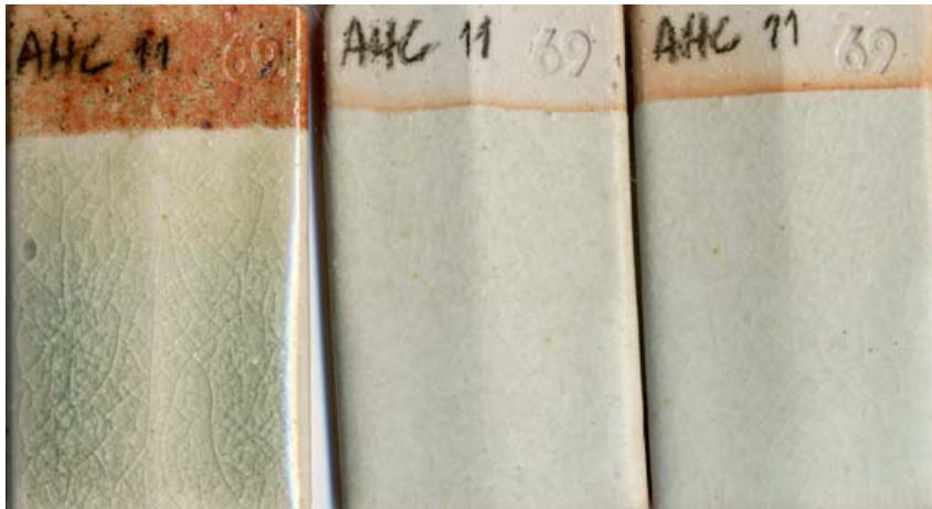
AHC11 celadon näytteet poltettu
