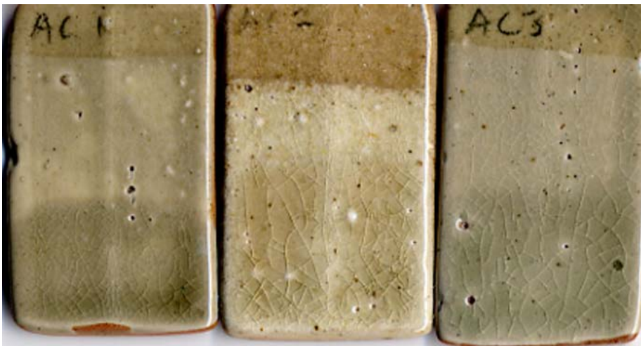
Alkaliset höyryt värjäävät massan punertavaksi celadon näytteiden reunoissa. Samanlaisia punertavia efektejä löytyy vanhoista museoihin säilytetyistä kiinalaisista celadon esineistä.
