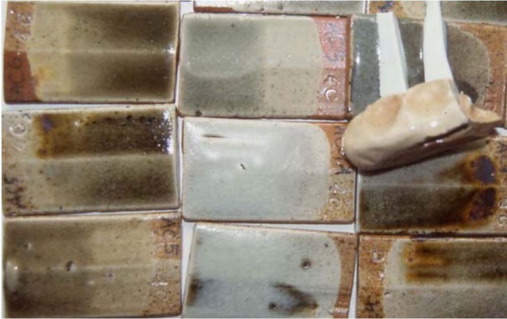
AC -celadon poltettuja näytteitä. Uunin lämpötilaa kontrolloivat keilat istutetaan saveen. Kuvan keilat ovat kaatuneet poltossa ja sulaneet kiinni näytteisiin.
